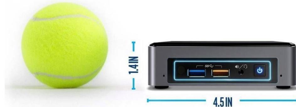
**ADScribe Box** è un'apparecchiatura che consente l'elaborazione di un segnale audio utile a generare, attraverso un software ad hoc sviluppato da Cedat 85 e installato sulla stessa, un file contenente la trascrizione del parlato in tempo reale.
